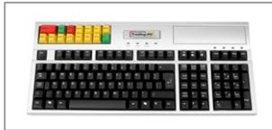
Um ein nahtloses Bedienkonzept für die beiden Arbeitsplatzworkstations zu erreichen, wurde die Händler-tastatur „Value“ eingesetzt. Diese ermöglicht die Steuerung aller Workstations mit nur einer Maus und Tastatur bei gleichzeitiger Verringerung des Platzbedarfes am Arbeitsplatz.
